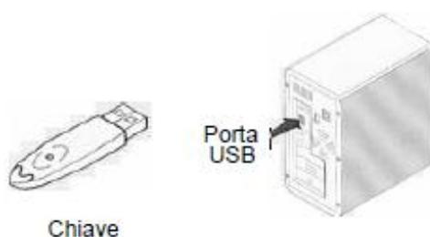
Se si utilizza una chiave USB e si dispone di varie porte USB, la chiave può essere inserita in una qualunque delle porte. Se non si ha a disposizione una porta USB, è possibile utilizzare un hub di espansione USB. I dispositivi USB sono hot-swap, quindi possono essere inseriti e disinseriti dal bus in qualunque momento, senza la necessità di riavviare il PC.
