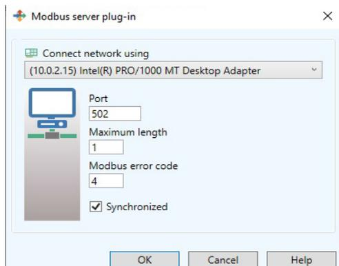
Le plug-in Serveur **Modbus** permet d'échanger des données simples entre un automate programmable et la sentinelle. Le protocole Modbus est un protocole série pour collecter des données et surveiller des lignes de production. Il est assez répandu et simple à mettre en œuvre. ( <https://en.wikipedia.org/wiki/Modbus> )
