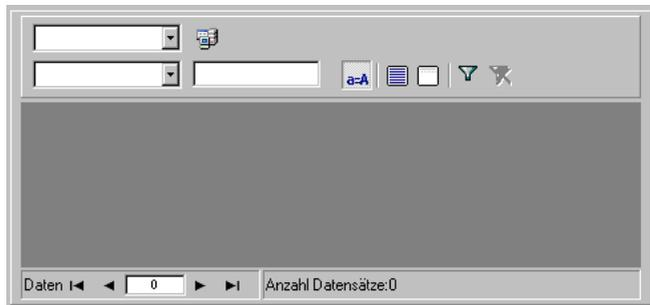
Ein DatabaseGrid ermöglicht dem Benutzer die Anzeige einer zuvor gewählten Datenbank. Beim Wählen einer Zeile wird das zugehörige Etikett im Vorschaufeld angezeigt. Der Benutzer kann mit dem DatabaseGrid **Hinzufügen**, **Löschen**, **Filtern** und nach Informationen **Suchen**.
