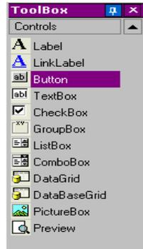
Chaque contrôle a une utilité propre. Ils peuvent être liés à des données fixes ou variables et peuvent être associés à des actions. Pour placer un contrôle sur votre formulaire, cliquez simplement sur le contrôle voulu, faites-le glisser et déposez-le sur le formulaire.
