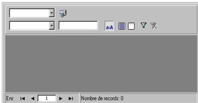
Une grille de base de données (Database Grid) permet à l'utilisateur de visualiser une base de données présélectionnée. Lorsqu'une ligne de la grille est sélectionnée, l'étiquette correspondante s'affiche dans la zone d'aperçu (Preview). L'utilisateur peut **Ajouter**, **Supprimer**, **Filtrer** et **Rechercher** des informations dans cette grille.
