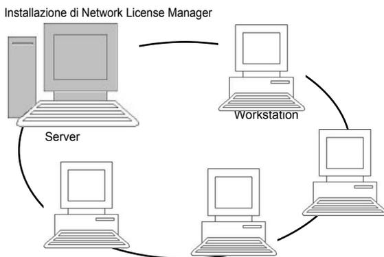
Figura 1 Installazione della configurazione di rete: installazione di **Network License Manager** sul server e installazione del software di etichettatura su ciascuna workstation.
