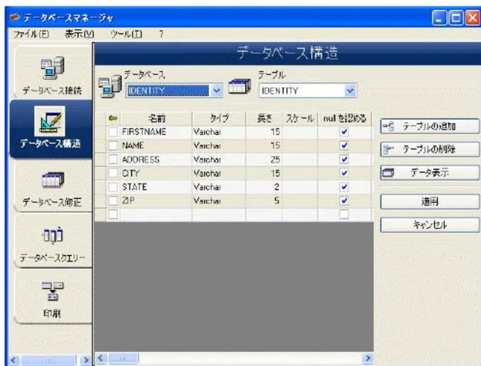
データベース構造ウィンドウを使用すると、テーブル / フィールドの追加、変更または削除など、データベースのファイル構造を管理することができます。
