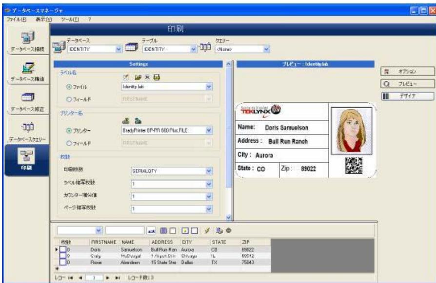
印刷ウィンドウを使用すると、印刷を開始する前に、印刷するファイルの選択、プリンターの指定、さまざまなパラメーターの定義を行うことができます。
