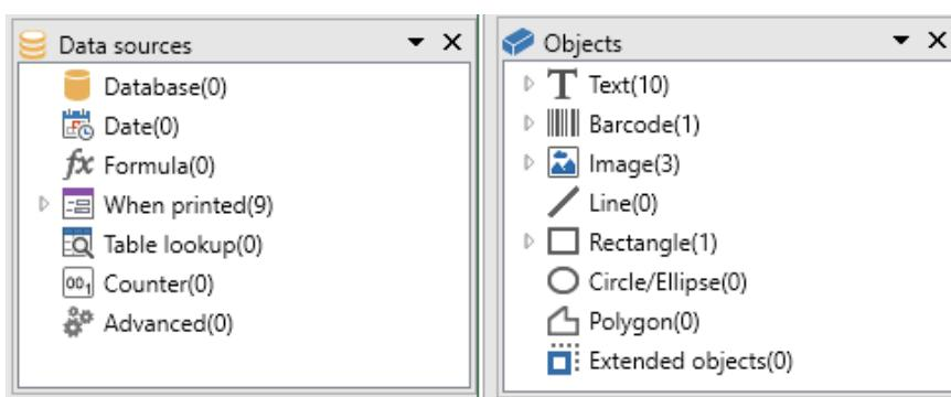
使用键盘上的向上箭头和向下箭头键可以在树结构中向上和向下移动。使用 + 和 - 符号可展开或收缩列表，以及显示与每个数据源关联的变量列表或每个类别中可用的对象。
