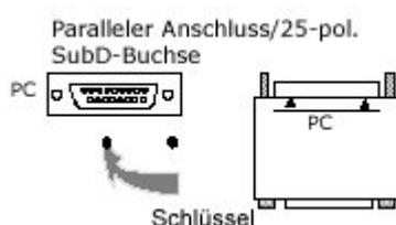
Falls Sie Ihren Drucker ebenfalls mit diesem parallelen Anschluss verbinden müssen, können Sie den Druckeranschluss problemlos auf den Softwarelizenzschlüssel aufstecken. Damit der Softwarelizenzschlüssel erkannt wird, müssen Sie möglicherweise den Drucker einschalten.
