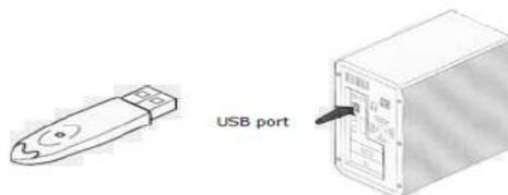
Falls Sie einen USB-Dongle verwenden und Ihr PC über mehrere USB-Anschlüsse verfügt, können Sie den Dongle mit jedem dieser USB-Anschlüsse verbinden. Ist kein USB-Anschluss an Ihrem PC verfügbar, können Sie einen USB Expander Hub verwenden. USB-Geräte sind Hot-Swap-fähig, d. h. dass Sie sie jederzeit an den Bus anschließen bzw. von diesem trennen können, ohne den PC neu starten zu müssen.
