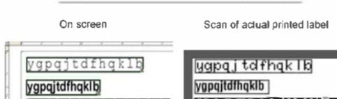
Comparaison entre l'aperçu écran d'une étiquette et le scan de son impression, pour un logiciel TEKLYNX et pour un logiciel concurrent.
